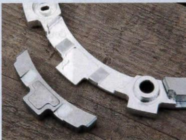
Voici l'intérieur du système. Grâce à la force centrifuge, les masselottes écartent les côtés du disque. Ingénieux !
