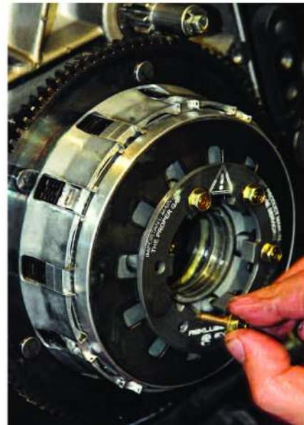
Maintenant on place le mécanisme centrifuge. Pas d'envers ni d'endroit à prendre en compte mais les taquets sur sa circonférence comportent les mêmes encoches que les disques garnis. Il faut impérativement les aligner en les plaçant dans la cloche d'embrayage. Remettez ensuite votre plateau de pression d'origine, puis le diaphragme et mettez en place le disque de maintien fourni avec ce kit.
