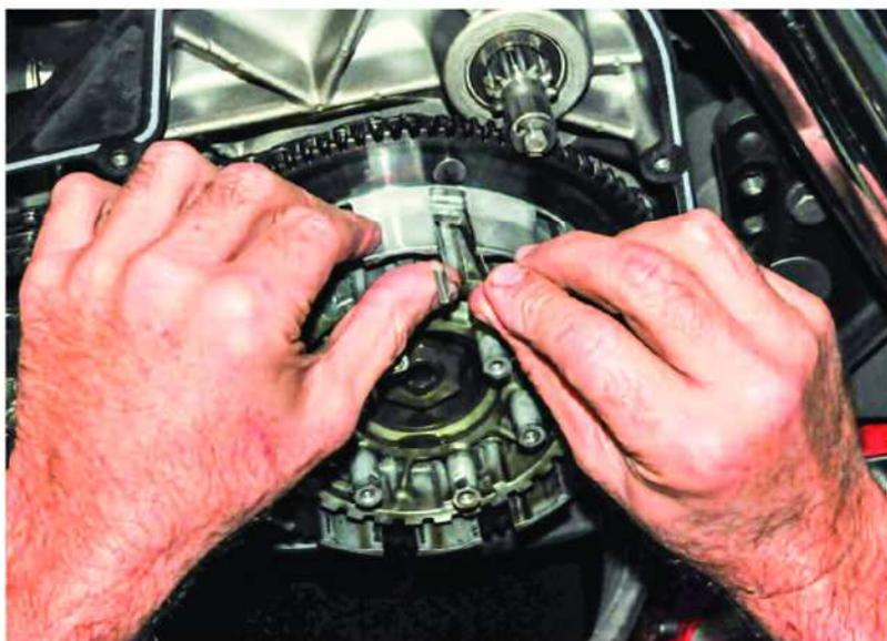
Avant de commencer à remonter, bien prendre soin de baigner les disques garnis et les lisses avec de l'huile de transmission.
