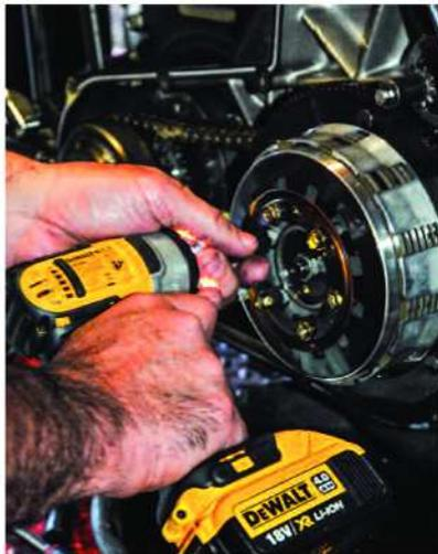
Rien de bien difficile à installer ce nouvel embrayage Rekluse. Dans un premier temps on vidange la transmission primaire, on enlève le carter et on attaque le désassemblage du mécanisme d'embrayage.
